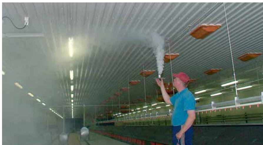
*La fumée permet de visualiser la circulation de l'air dans un abri d'animaux afin d'optimiser la conception du système de ventilation.*
