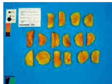
Analyysi perunalastujen laadun heikentymisestä varastotilojen korkeiden CO 2 -pitoisuuksien vuoksi. Kuvan lähde: Techmark, Inc.
