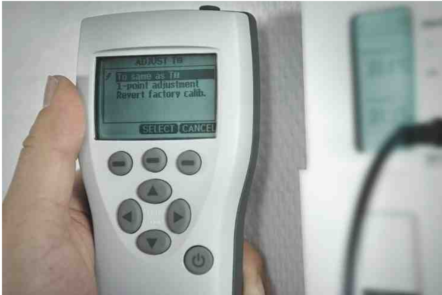
Das Anzeigegerät MI70 in Verbindung mit einer Messsonde eignet sich für Stichprobenmessungen und zur Kalibrierung.
