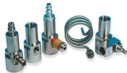
*Les cellules d'échantillonnage (à partir de la gauche) DMT242SC2, DMT242SC et DSC74 peuvent s'utiliser pour raccorder le DM70 à un gaz échantillon. Le modèle DSC74B (à droite) est une cellule d'échantillonnage à double pression pouvant s'utiliser pour des mesures soit sous pression, soit à la pression atmosphérique. Un serpentin de refroidissement/aération est inclus dans la cellule d'échantillonnage DSC74C, mais est en option dans toutes les autres cellules.*
