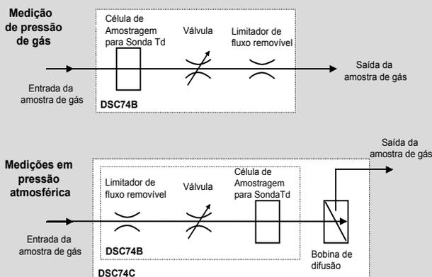
A célula de amostragem DSC74B permite a medição da amostra de gás, quer em pressão de gás de até 10 bar ou na pressão atmosférica, dependendo da entrada ou saída de gás. O DSC74C é similar ao DSC74B mas com uma bobina adicional para evitar difusão de volta, o efeito da umidade circundante, nas medições do ponto de orvalho em pressão atmosférica.
