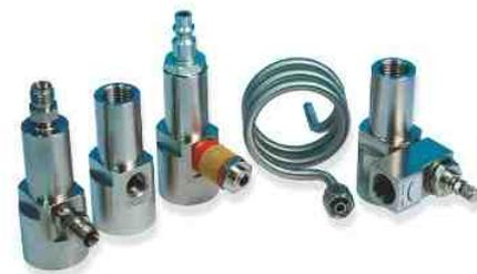
*As células de amostragem DMT242SC2, DMT242SC e DSC74 (a partir da esquerda) podem ser usadas para conectar o DM70 às amostras de fluxo de gás. O DSC74B (à direita) é uma célula de amostragem de pressão dupla que pode ser utilizada para medições em qualquer pressão ou pressão ambiente. A bobina de resfrição/ventilação está incluída na célula de amostragem DSC74C, sendo uma opção para todas as células de amostragem.*
