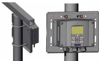
Installation sur mât avec kit d'installation pour mât ou conduite
