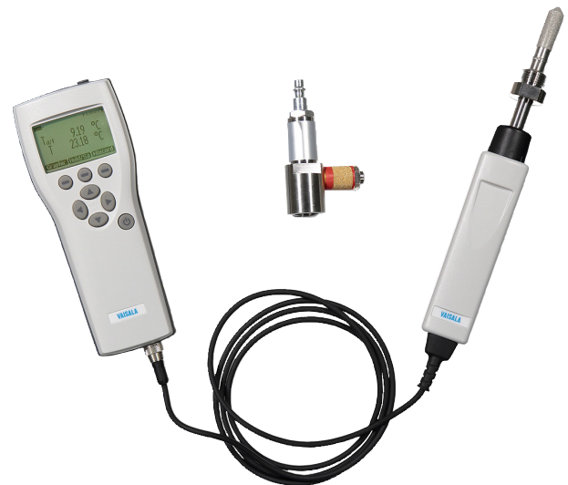
Vaisalan kannettava mittalaite DM70
