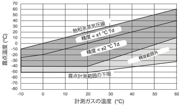
精度 (A プローブ)  $\pm 2^\circ\text{C}$  (グラフ参照)
