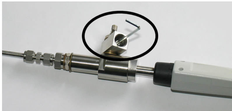
Abbildung 30 Entfernen der Ablassschraube
