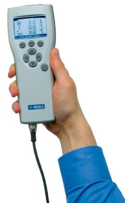
L'indicateur portable de point de rosée Vaisala DRYCAP® DM70 est idéal pour la vérification des transmetteurs DMT340 sur le terrain.
