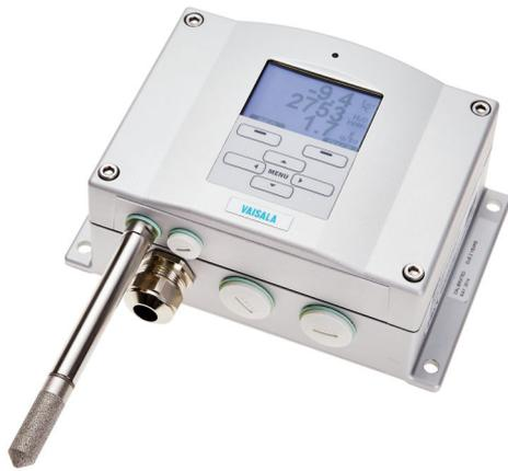
L'affichage du DMT341 indique les tendances de mesure, les données en temps réel et l'historique de mesure. Le DMT341 est conçu pour les installations dans les salles sèches où le transmetteur de point de rosée doit se trouver à l'intérieur de l'environnement sec. L'instrument est facile à nettoyer et approprié pour les salles blanches.
