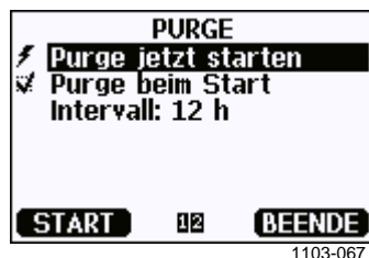
Abb. 74 Einstellungen für die Sensorreinigung
