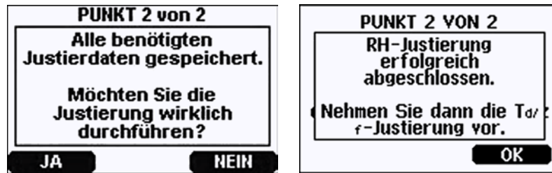
Abb. 87 Abschließen der Justierung von Punkt 2
