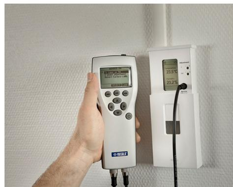
Calibração no local com o Medidor portátil HM70
