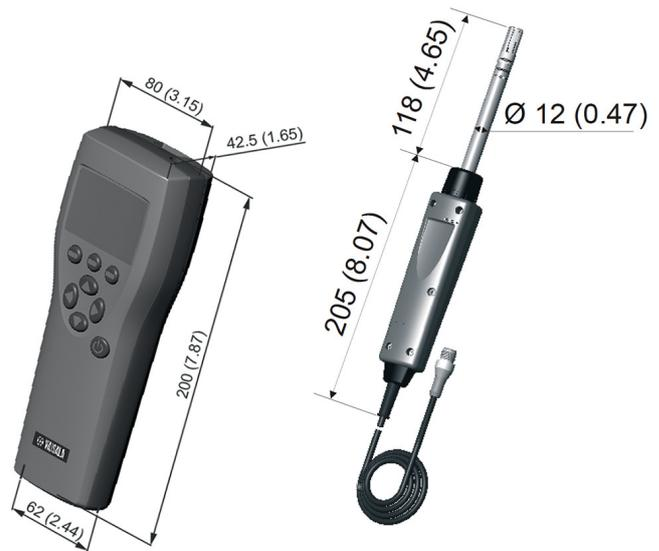
Dimensões da sonda HMP75 e do indicador MI70 em mm (polegadas)
