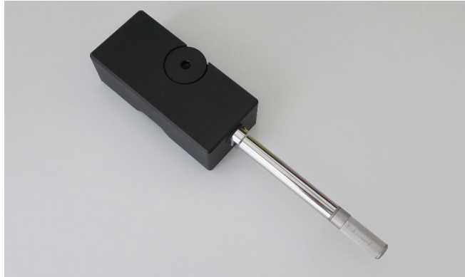
스테인리스 스틸 넷트 필터가 있는 HMP371 측정부
