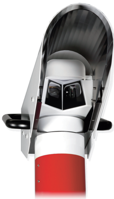
Фактическая компенсация загрязнения окна на основе V-образных окон
