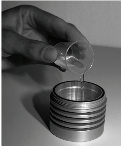
Figure 3 Versez la quantité appropriée d'eau désionisée dans le récipient, puis séchez le verre doseur.
