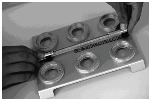
Figure 10 Placez le thermomètre sur son support lorsque vous ne l'utilisez pas.
