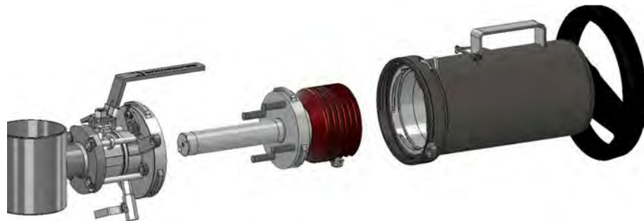
Figura 11.1 Sistema Safe-Drive™ : isolamento da válvula, sensor PR-23-SD, retractor
