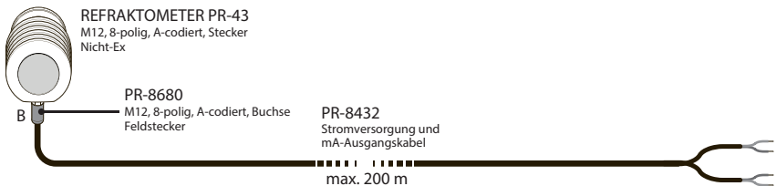
Abbildung 5 Verdrahtung nur für Analogausgang
