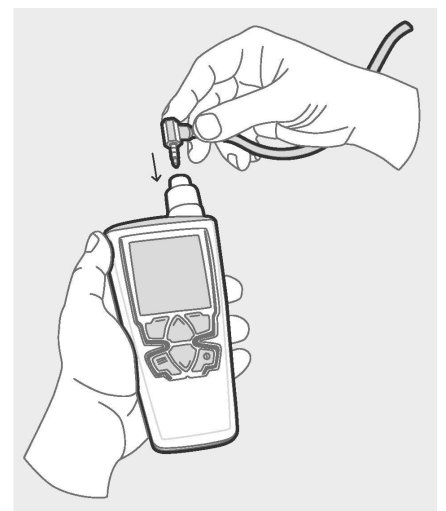
Mätprobens kontakt del ansluts till indikator HM40 för avläsning av mätresultat.
