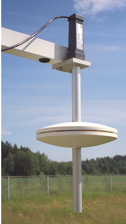
SPH10/20は取り付けが簡単です。写真のSPH10はPTB210に接続されています。
