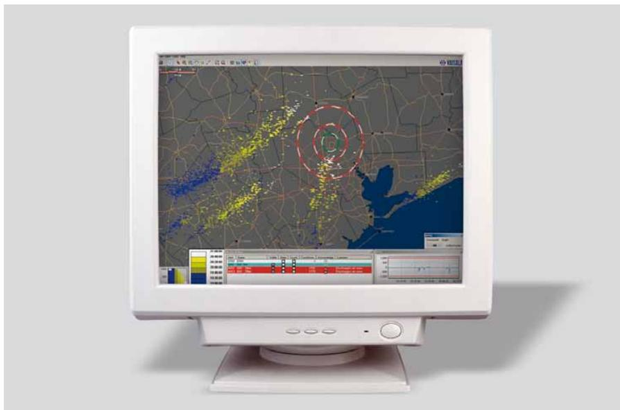
La aplicación principal monitorea en tiempo real las áreas de alerta de rayos y los sensores de campo eléctrico. En cuanto la estación de trabajo TWX300 emite un alerta de rayos se activan visualizadores remotos de alarma, notificaciones por correo electrónico y relés.
