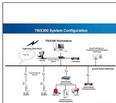
La instalación típica del sistema de alarma de tormentas eléctricas Vaisala TWX300 se acopla con una red local existente para conectarse a la red central de rayos y a las fuentes de datos locales de sensores de campo eléctrico. Las alarmas se distribuyen por el sistema de visualización remota de alarmas (RADS), notificaciones de correo electrónico y relés.
