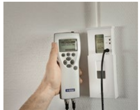
使用 HM70 手持式仪表进行现场校准
