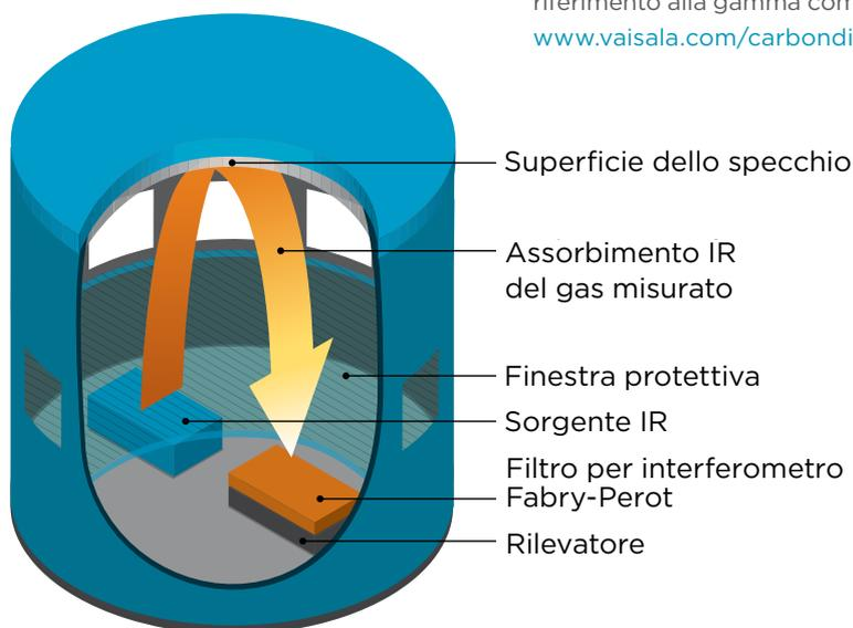
Struttura del sensore CARBOCAP®.
