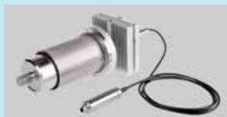
维萨拉 DRYCAP® DMP6 设计用于具有很高温度（高达 350°C）的工业干燥应用中的湿度测量。使用被动冷却装置来实现耐高温，该装置带走探头的热量，将温度降低到传感器的最佳测量范围内。
