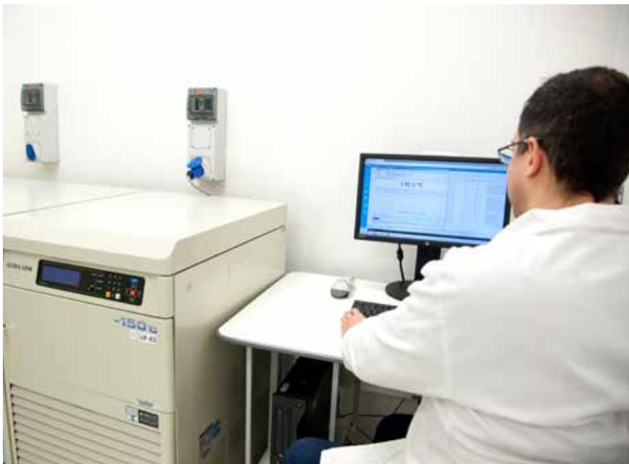
Dr. Motta contrôlant l'état d'un congélateur cryogénique dans une fenêtre d'alarme contextuelle de viewLinc.
