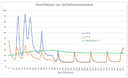
"Die Grafiken zeigen, wie wichtig es ist, sowohl die relative Sättigung als auch die relative Feuchte während eines Prozesses zu kennen. Dies gilt insbesondere für die Desinfektion von Geräten mit HEPA-Filtern.
