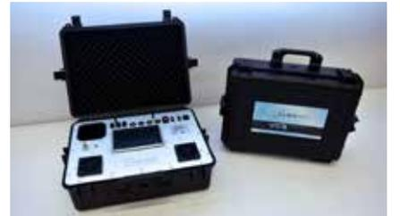
“无论您是正在给驾驶舱、救护车、隔离器还是操作室（可能被污染的实际任何区域）净化，都需要在线传感器，这些传感器不仅要提供  $H_2O_2$  蒸汽值，还要提供相对饱和度值，因为它将在当前温度下将发生冷凝时向您指出此情况。相对饱和度指示由于水汽和过氧化氢蒸汽混合而导致的湿度值。”
