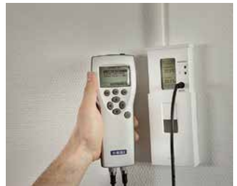
使用 HM70 手持式仪表进行现场校准
