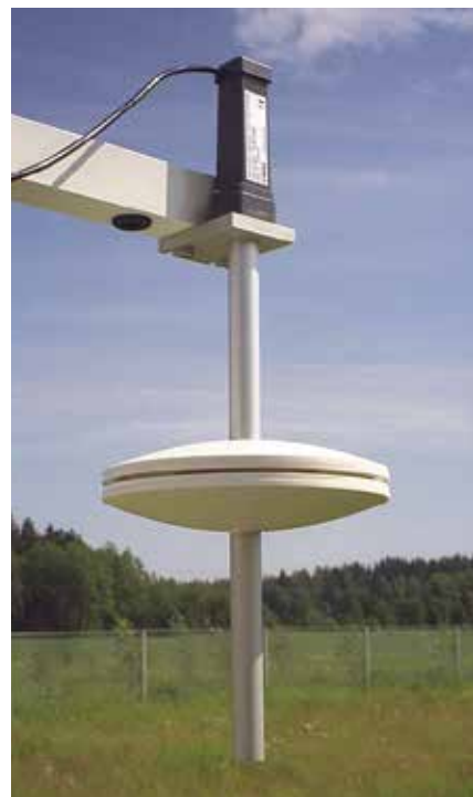
SPH10/20容易安装和连接。图中为SPH10静压头与PTB210气压表的连接。
