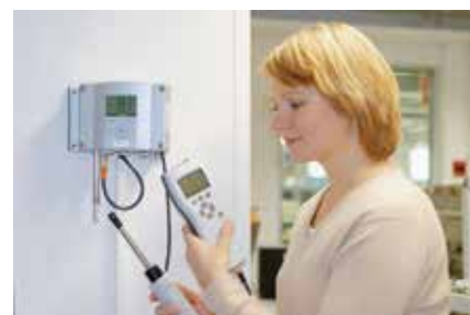
手持式温湿度仪表HM70适用于现场检查HMT330变送器
