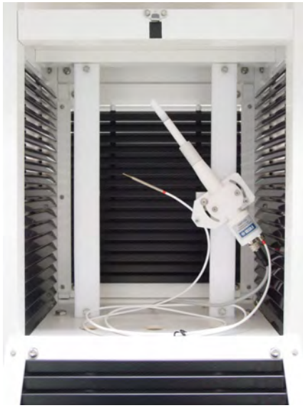
百葉箱への取り付けキット(オプション)を使用したHMP155本体と追加温度プローブ
