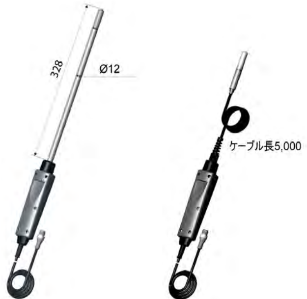
HMP76およびHMP77プローブ(ケーブル付)の寸法:mm
