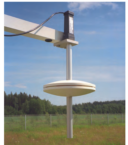
SPH10 屋外気圧取入れ口と組み合わせた PTB210
