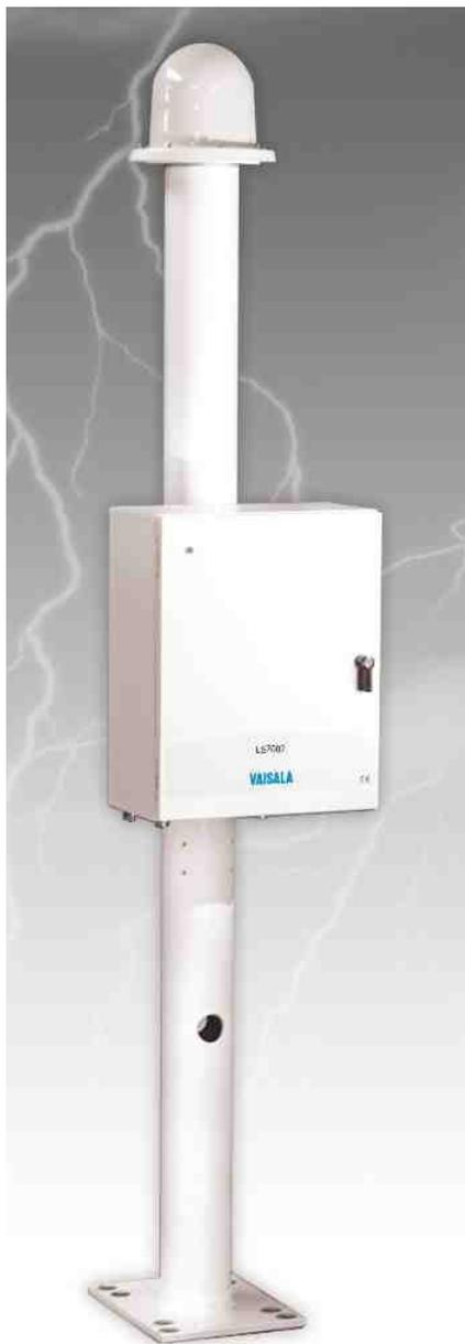
*Le réseau du capteur de Foudre™ détecte les éclairs et les éclairs nuage-sol avec une grande efficacité et une excellente précision dans la localisation. Il utilise une technologie combinée et permet de couvrir une large zone avec moins de capteurs, ce qui réduit les coûts de fonctionnement du réseau à vie par rapport à toute autre technologie.*
