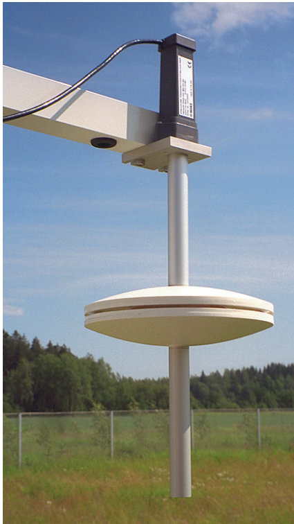
SPH10/20は取り付けが簡単です。写真のSPH10はPTB210に接続されています。
