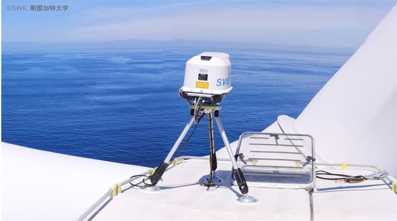
WindCube® Nacelle 激光雷达的可靠性和准确度较高，符合 IEC 标准对功率曲线测试 (PPT) 的要求。借助其可靠的数据和易用性（适用于陆上和海上），有助于提高您的风电场发电量和项目盈利能力。
