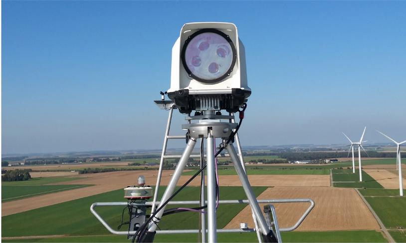
WindCube® Nacelle 激光雷达使运营商能够高效、准确地评估和验证性能，以提高发电量。符合 IEC 标准，适用于进行合同和运行功率曲线测试 (PPT)。借助其可靠的数据和易用性，可以提高您的风电场发电量和项目盈利能力。
