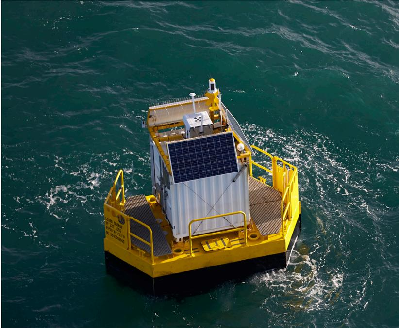
WindCube® Offshore 是一款可用于风能开发和运营多个阶段的参考激光雷达，其设计采用了坚固的、为海洋用途而处理的外壳，可集成到浮标及其他条件苛刻的海上环境，例如灯塔、变电站和船舶。
