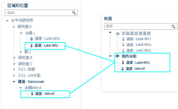
视图经过设置，可显示新仪表板图像上的位置状态，或显示所选位置的趋势图形（在远程显示终端上显示视图时，会非常有用）。请在**视图管理器**中创建新的视图，然后在**概述**窗口中访问这些视图。
