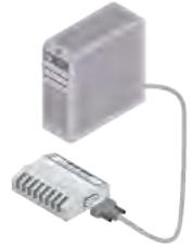
与 USB 或串行电缆连接的 DL 数据记录仪
